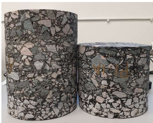
Figur 19. Två provkroppar uppborrade ur Rv 40, den vänstra från referenssträckan och den högra från P1. Tjockleken är ca 190 mm på referenssträckan och 140 mm på P1–P4. Båda provkroppar är vända upp och ner (slitlagret nedåt) i fotot.
